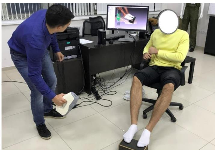
**Рисунок 1. Оцифровка формы ног портативным сканером Artec 3D Eva**
