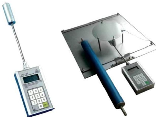
**Рисунок 1. Прибор для измерения напряженности электростатического поля СТ-01**
